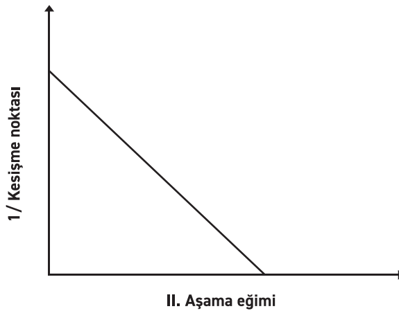
Şekil 6.5. Kömürün kendiliğinden yanma karakteristikleri tarafından oluşturulan üçgen (Gouws ve Wade 1989, Eroğlu 1992).
