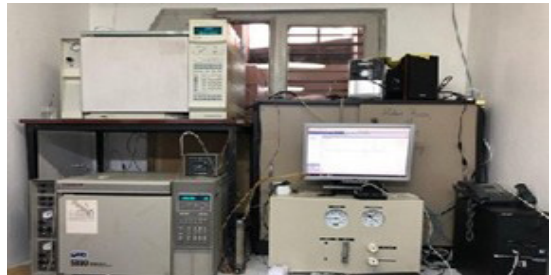
Şekil 7.2. Kendiliğinden yanmaya yatkınlığı ve çıkan gazların belirlenmesinde kullanılan deney seti.
